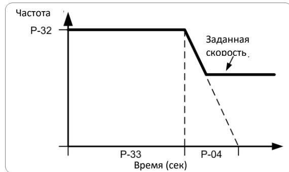
Процедура оптимизации и настройки устойчивого пуска однофазного двигателя:
